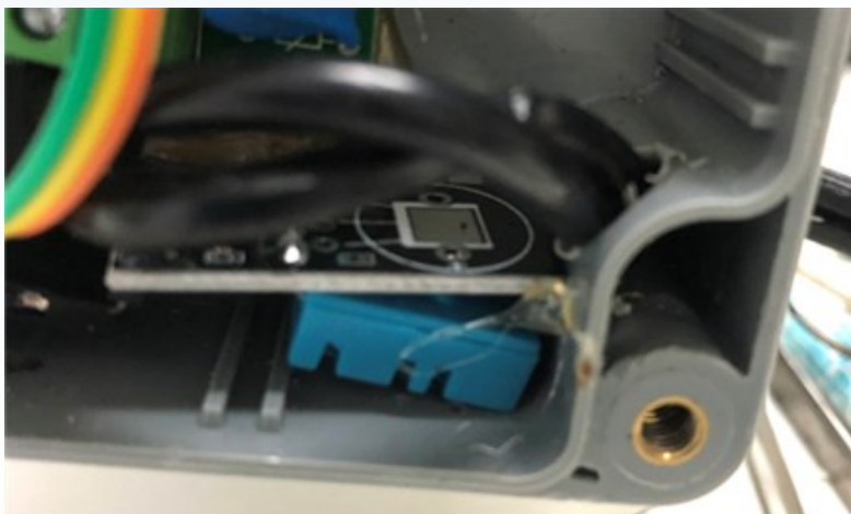
圖8、結合溫濕度感測模組模組（DHT 11）實作之溫溼度感應器。
