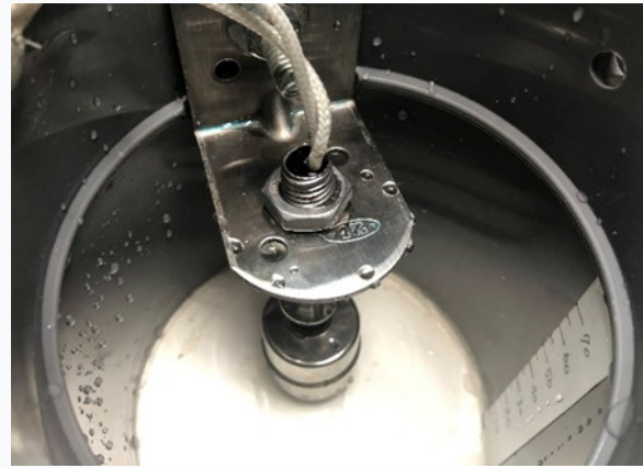
圖7、物理性磁動液位感應器。
