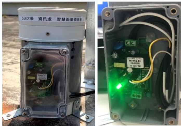
圖5、本計畫以ESP8266實作的微氣象站。
